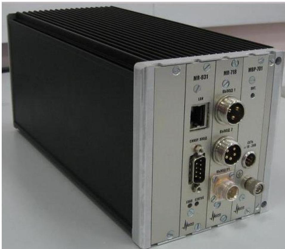
Рисунок 9. Внешний вид имитатора телеметрических сигналов ME-718.
