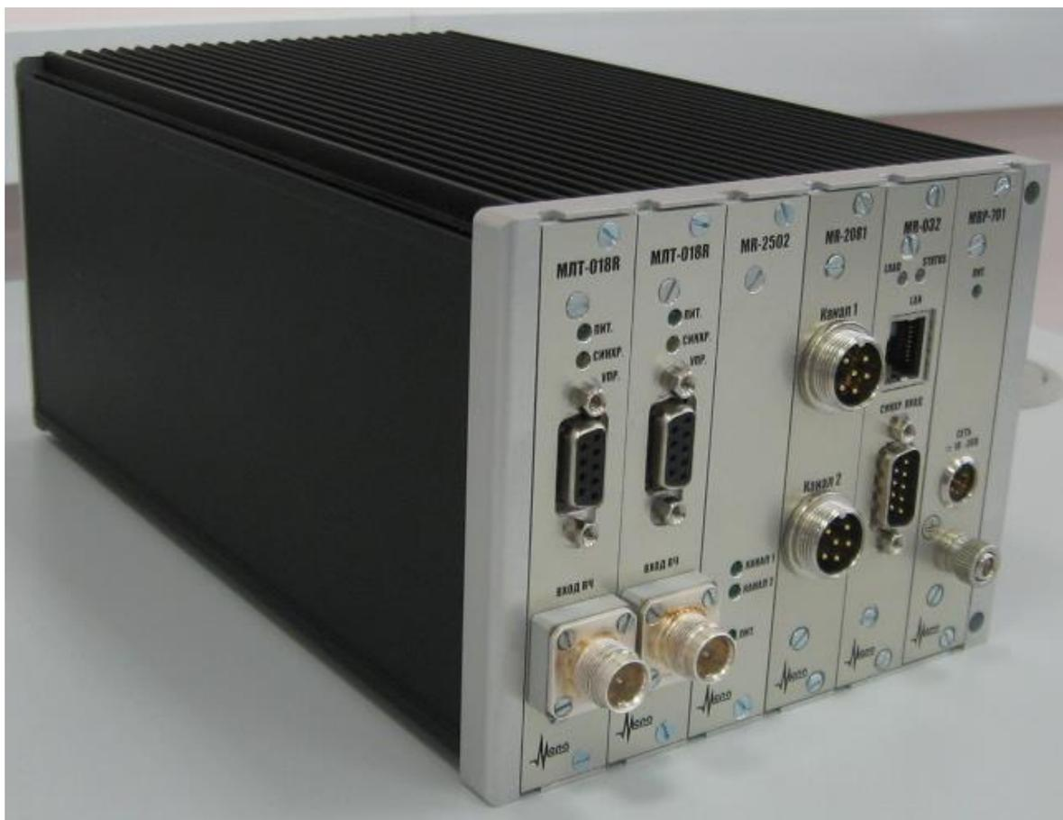
Рисунок 1. Внешний вид устройства приёма и демодуляции МІС-ТМ.
